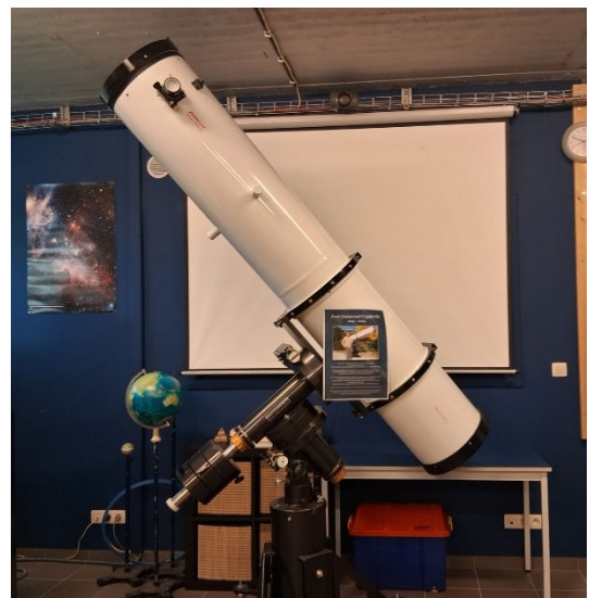
Télescope Newton de 350 mm avec monture équatoriale Parallax : don de José Guinovart Capdevila (1945-2025) à l'observatoire du Centre-Ardenne.
