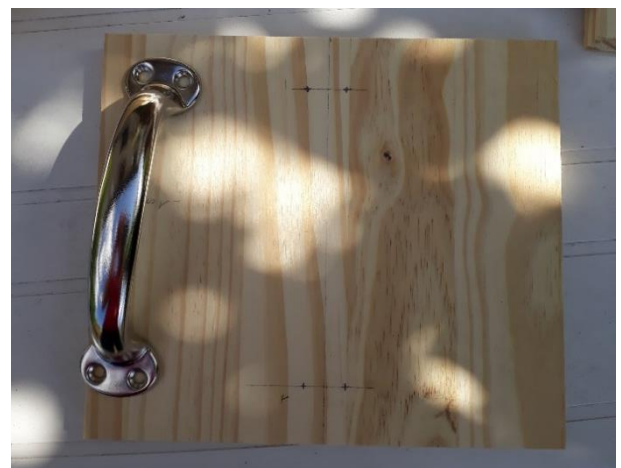
Figure 12 : Poignée et emplacements des vis marqués au pointeau.
