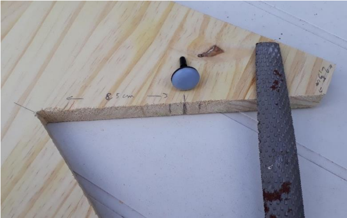
Figure 10 : Logements des patins de téflon.
