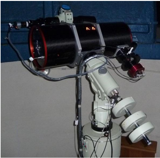
Figure 5. Matériel utilisé : télescope Newton de 250 mm et caméra Atik 11000 .
