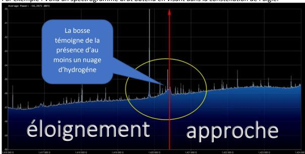
Par exemple: Voila un spectrogramme brut obtenu en visant dans la constellation de l'aigle.
