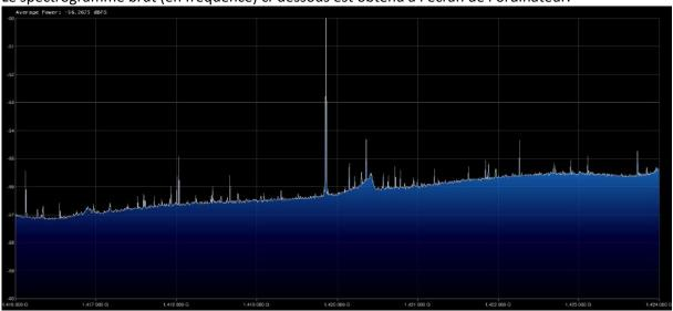
A partir du spectrogramme brut l'ordinateur calcul le spectrogramme ci-dessous en <u>vitesse radiale</u>. La vitesse radiale est la vitesse relative entre nous et les nuages sur la ligne de visée. C'est la relation de <u>Doppler-Fizeau</u> lie la fréquence et la vitesse.
